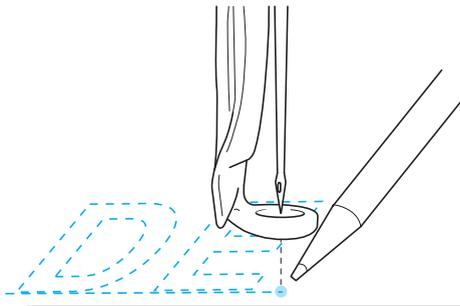
**6** Снимите пяльцы с машины, а затем соедините эти две точки, чтобы отметить позицию вышивания.
