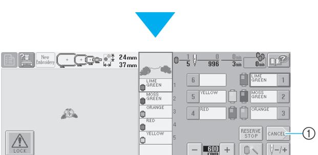
На экране вышивки проверьте цвета нитей, назначенные игловодителем, а затем установите верхние нити. Нажмите кнопку
