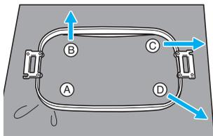
Сначала совместите и выровняйте внутренний и внешний обода палец в углу, в котором находится винт (угол А). Затем, слегка натягивая ткань в направлении, указанном стрелкой В, вставьте внутренний обод палец в углу В. Подобным образом, слегка натяните ткань в направлении, указанном стрелкой С, и вставьте обод в углу С, а затем слегка натяните ткань в направлении, указанном стрелкой D, и вставьте обод в углу D.
