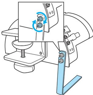
Установите монтажное приспособление на устойчивую монтажную поверхность, например на стол.
