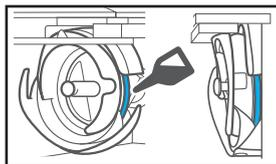
Ежедневно перед использованием машины следует капнуть каплю смазочного масла на челнок.
