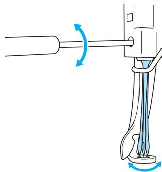
**3** Вставьте иглу плоской стороной, обращенной к задней части машины, и до упора (до тех пор, пока она не коснется ограничителя в игловодителе) вдвиньте ее вверх.
