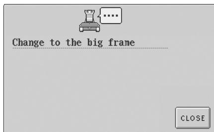
Вышивальная машина определяет, какие установлены пяльцы, по положению левого держателя пялец. Таким образом, размер пялец определяется по положению левого держателя, даже если пяльцы, которые определила машина, на самом деле не установлены. Кроме того, если рама для установки пялец вообще не установлена, вышивальная машина определяет, что установлено устройство для
