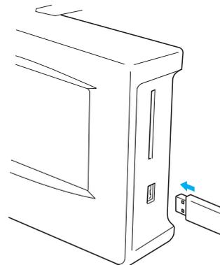
При подключении USB-устройства чтения/записи карт к USB-порту типа “А” (главному) машины закрепите кабель в трех фиксаторах, расположенных на задней панели. Если кабель не закрепить должным образом, пальцы при перемещении могут
