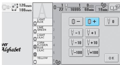
► При каждом нажатии этой клавиши выбирается следующий цвет в отображении последовательности цветов нитей. При достижении последнего в этой последовательности цвета прокрутка прекращается.
