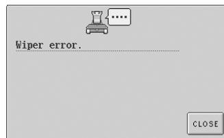
**Неисправность приспособления для захвата нити.**
