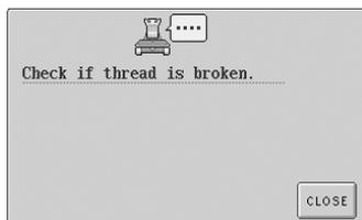
**Верхняя нить была обрезана или она соскользнула с регулятора натяжения или с нитенаправителя. Нить в машину заправлена неправильно.**
