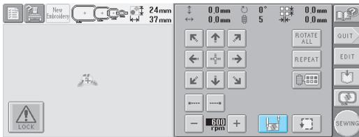
Для установки начальной позиции нажмите кнопку
