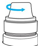
Ослабьте натяжение нити, повернув регулятор натяжения против часовой стрелки.
